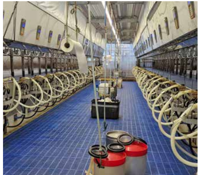
Die Kühe der Möck Milch werden in einem Doppel 24er Side-by-Side Melkstand gemolken
